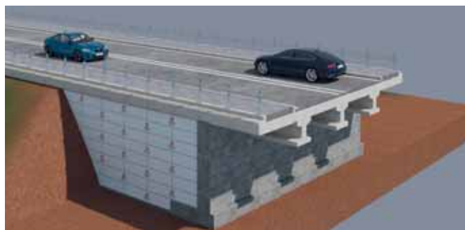
Слика 2 Спречавање усељавања у конструкције за приступ мосту и пуњење падина меког тла.
