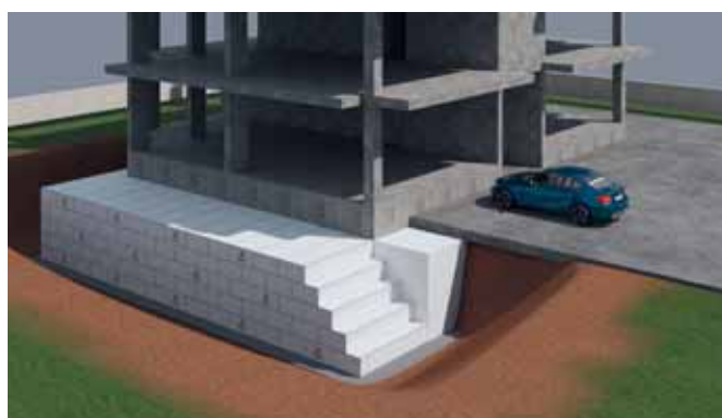
Слика 4 Попуњавање апликација за смањење бочних оптерећења потпорних конструкција и темеља.
