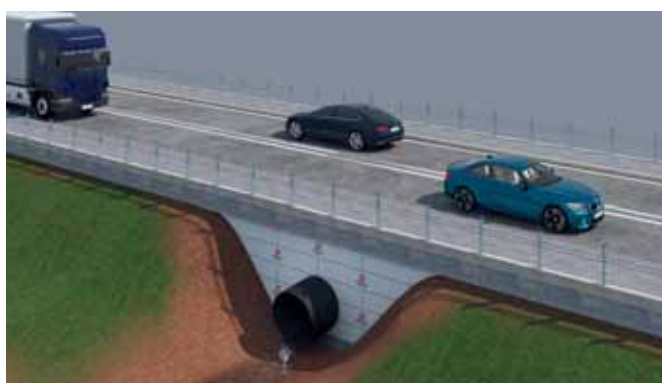
Слика 3 Пуњење ради заштите подземних цевовода, одводних и инфраструктурних објеката који су изложени великом вертикалном оптерећењу.
