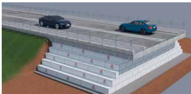
Слика 1 Начин који се користи за замену пуњења земљом, код аутопутева, мостова и рампи при чему олакшава оптерећење дизајна.
